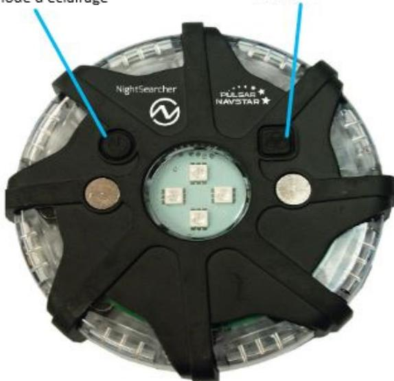
1: Retirer les pulsars de la mallette et placer en un sur le sol. Une lumière ambré apparaîtra et le pulsar sera automatiquement en mode flash.
